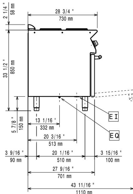
EI = Conexión eléctrica (energía)
